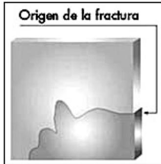
Fig. 8.5: Fractura por stress térmico de baja tensión (gentileza VASA).
