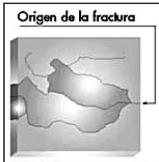
Fig. 8.6: Fractura por stress térmico de alta tensión (gentileza VASA).
