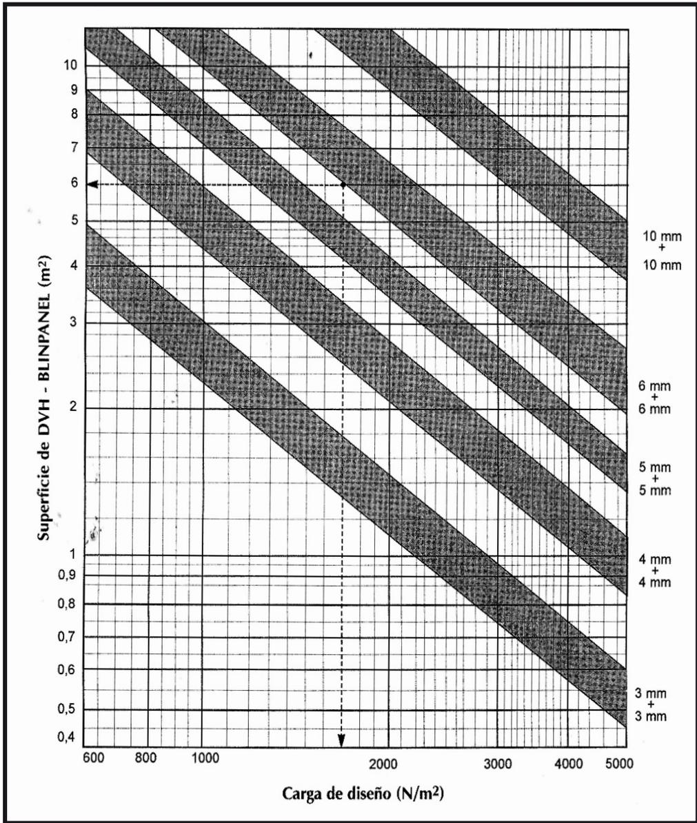
Fig. 11.3: Doble vidriado hermético, soportado en sus cuatro bordes.
